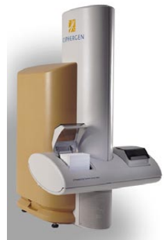
Geldarstellung (obere Abb.), SELDI-TOF-Massenspektrometer (linke Abb.)
